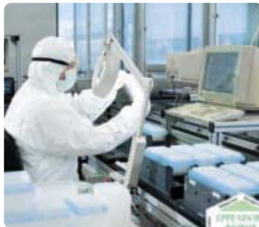
Eppendorf Biopur-Produkte werden unter Reinraumbedingungen hergestellt. Automatisierte Produktionsprozesse und ständige Qualitätskontrollen schließen jegliche Kontamination mit biologischen Substanzen aus.
