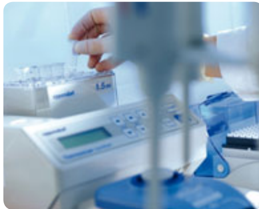
Mit Hilfe des Thermomixers comfort wird die DNA freigelegt.
