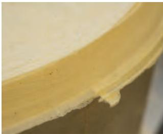
Dank des Trennmittels verbindet sich der Spezialschaum (Nahaufnahme) nicht mit der Verschäumungsform.
