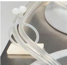
Abb. 1: Führung der Dosierleitungen mit Hilfe von Kabeldrillern
