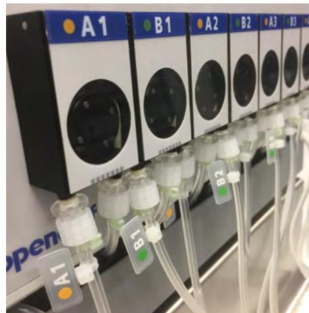
Abb. 2: Dosierleitung mit neuer Beschriftung, bestehend aus Kabelbinder, Kennschild und selbstklebendem Etikett
