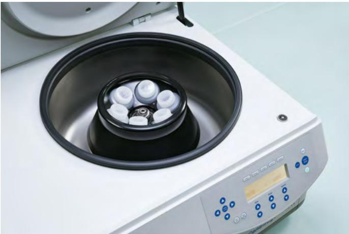
Festwinkelrotor mit hoher Kapazität für ein weites Anwendungsspektrum mit max. Beschleunigung von 15,054 x g (10,100 rpm)
