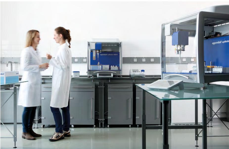
Resultate, die von einem Pipettierautomaten unterstützt wurden, sind hingegen einfacher zu reproduzieren. Die Leistung und Qualität von automatisierten Prozessen bleibt konstant, egal zu welcher Tages- oder Nachtzeit gearbeitet wird. Werden Pipettierautomaten für Routineaufgaben eingesetzt, können diese von mehreren Mitarbeitern genutzt werden, wobei die Pipettiervorgänge immer auf die gleiche Weise durchgeführt werden.
