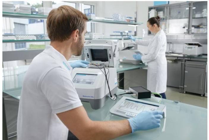
Eppendorf Servicetechniker bei einer Multikanal-Temperaturverifizierung des Mastercycler® X50s
