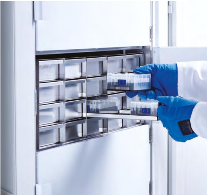
$-80^{\circ}\text{C}$ -Lagerung im CryoCube F740hi Freezer
